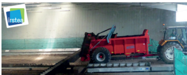
Photo 1. Les performances des épandeurs sont certifiées au banc d'essai - Station des Cormiers.
